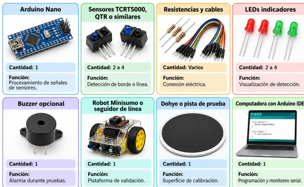
Figura 7.3: Materiales utilizados para el sistema de sensores de borde inteligentes.
