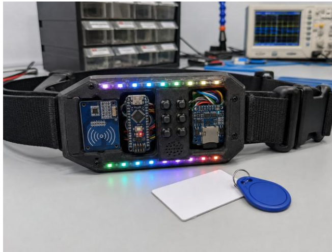
Figura 8.1: Prototipo de cinturón interactivo con efectos de luz y sonido.
