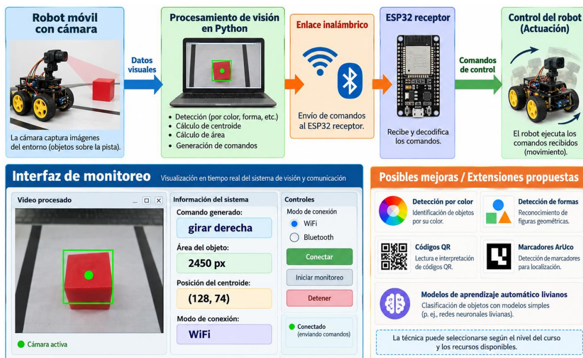
Figura 13.10: Extensión del sistema de visión con interfaz de monitoreo.
