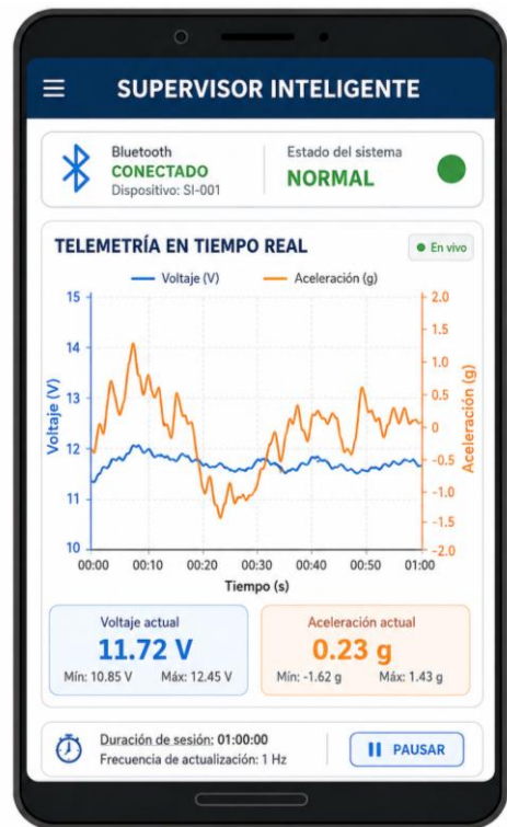
Figura 4.10: Análisis de telemetría del supervisor durante una prueba dinámica.
