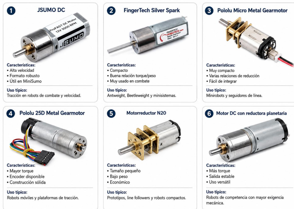
Figura 2.8: Actuadores utilizados en robótica competitiva, wearables e instrumentación.
