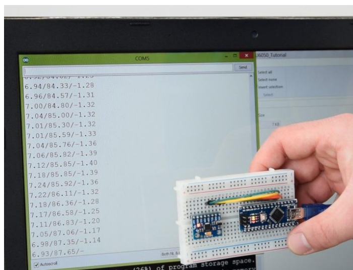
Figura 5.5: Conexiones del sistema de telemetría de impactos.
