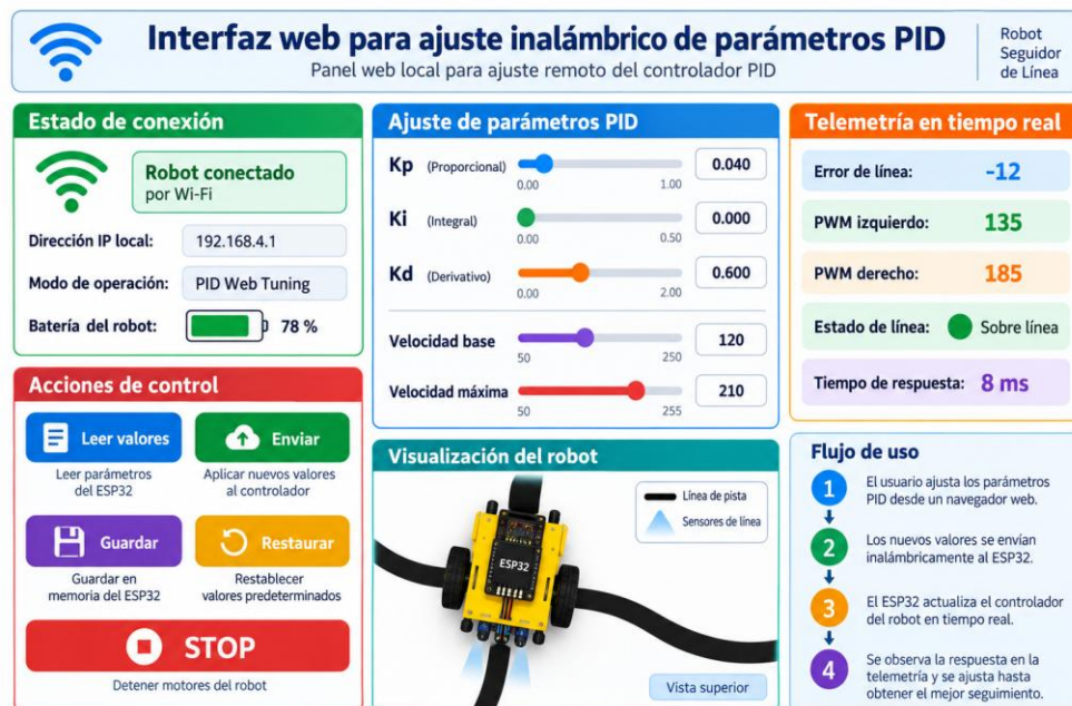
Figura 12.6: Interfaz web para ajuste inalámbrico de parámetros PID.
