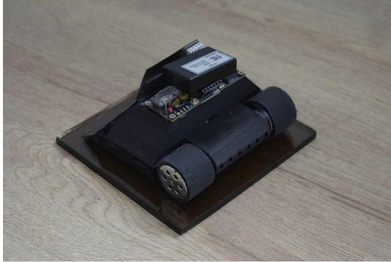
Figura 4.1: Robot competitivo como plataforma de integración del supervisor inteligente.
