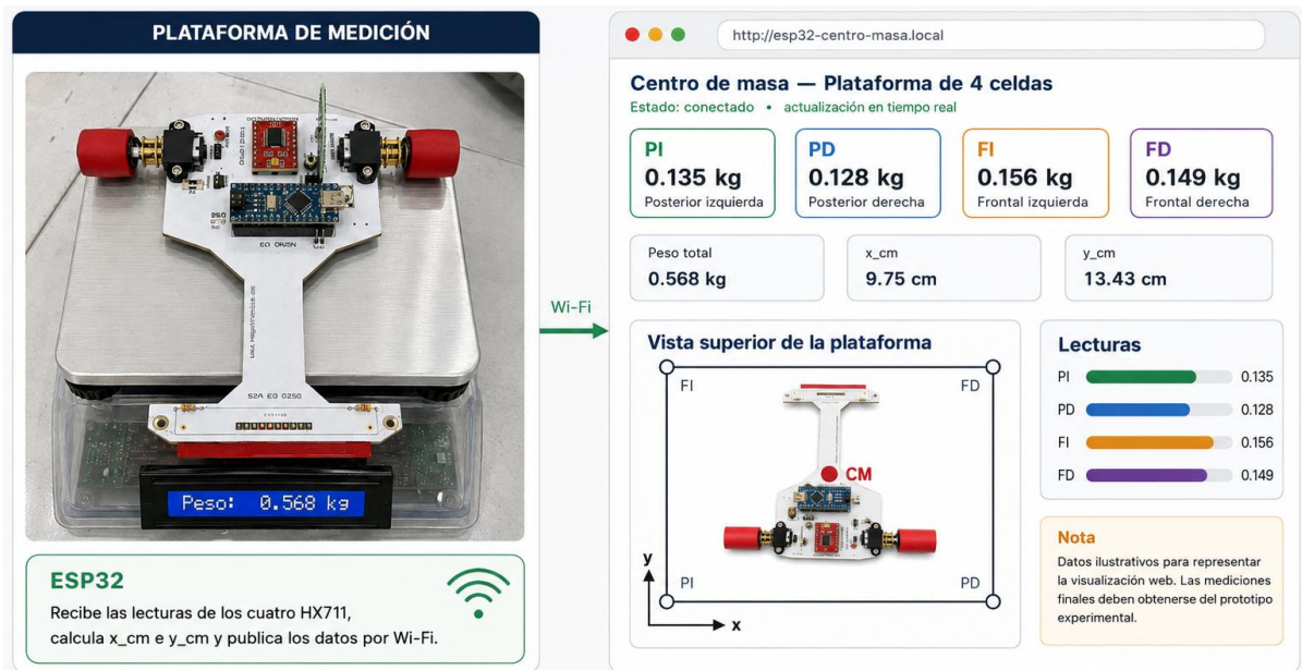
Figura 10.13: Extensión con ESP32 y visualización web del centro de masa.
