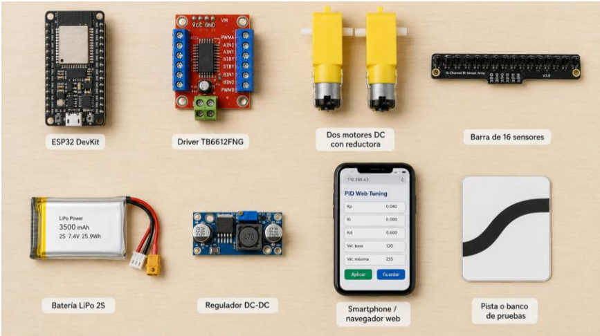
Figura 12.3: Materiales utilizados para implementar PID Web Tuning.
