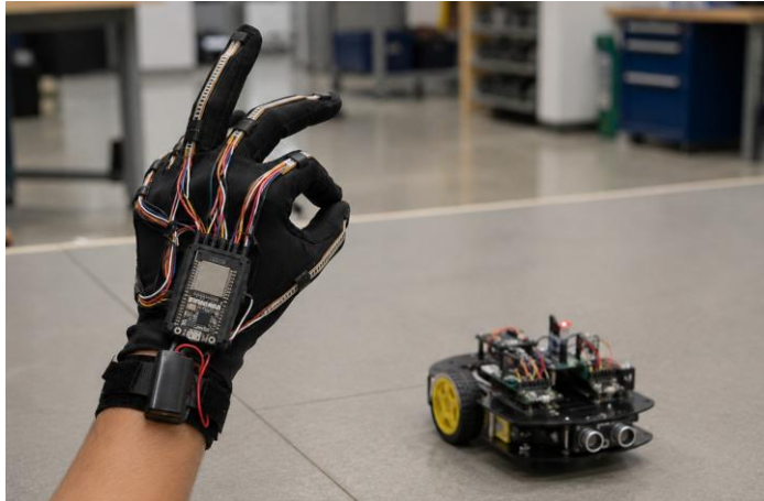
Figura 9.8: Control inalámbrico de un robot mediante guantelete de gestos.
