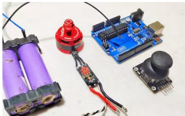
Figura 6.3: Materiales utilizados para el control seguro de motores brushless.
