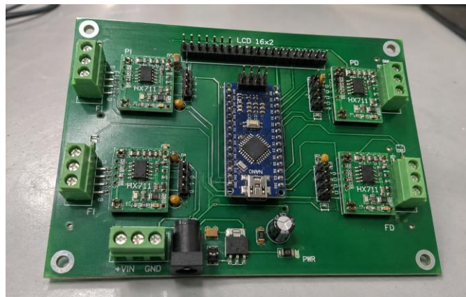
Figura 10.6: Montaje electrónico de la plataforma de medición de centro de masa.
