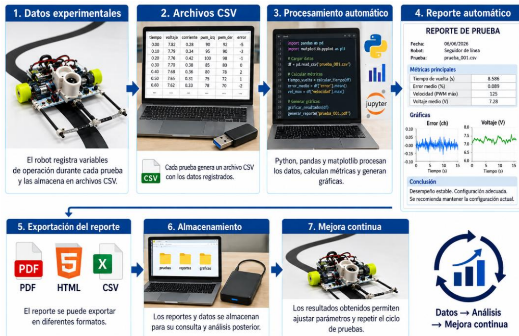
Figura 19.6: Extensión con generación automática de reportes de prueba.
