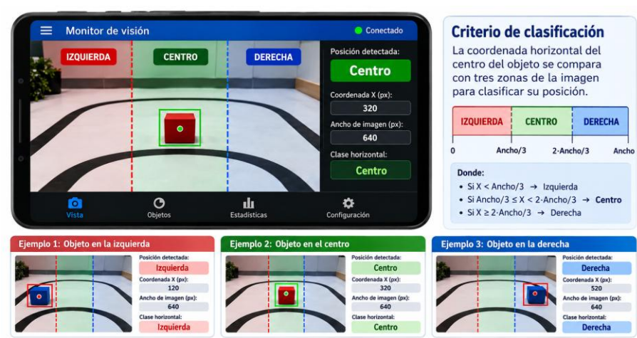
Figura 13.7: Clasificación de posición horizontal del objeto detectado.
