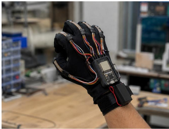
Figura 9.6: Montaje físico del guantelete de control por gestos.
