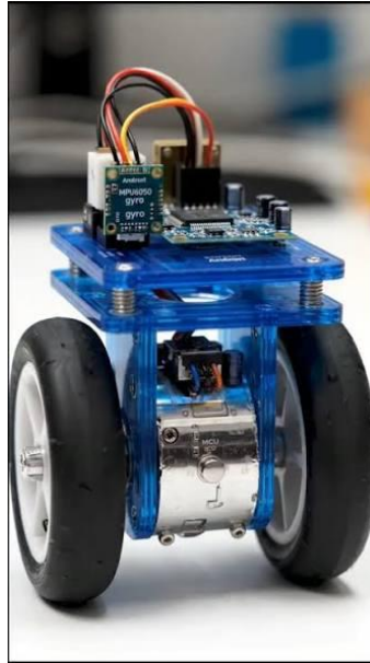
Figura 5.1: Robot competitivo instrumentado con sensor inercial para registro de impactos.
