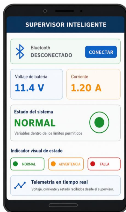
Figura 4.9: Aplicación móvil para visualización de telemetría del supervisor inteligente.
