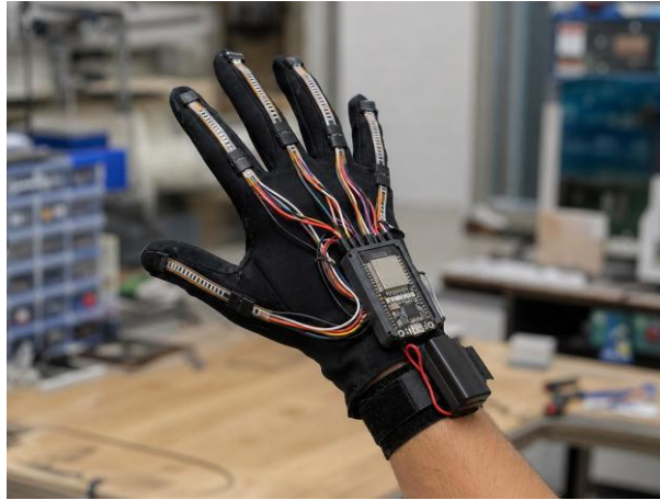
Figura 9.1: Guantelete de control por gestos basado en ESP32 y sensores flexibles.
