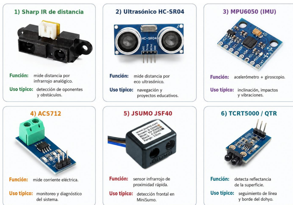
Figura 2.7: Sensores utilizados en robots competitivos y sistemas inteligentes.
