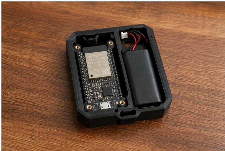
Figura 9.10: Diseño mecánico sugerido para el guantelete de control.
