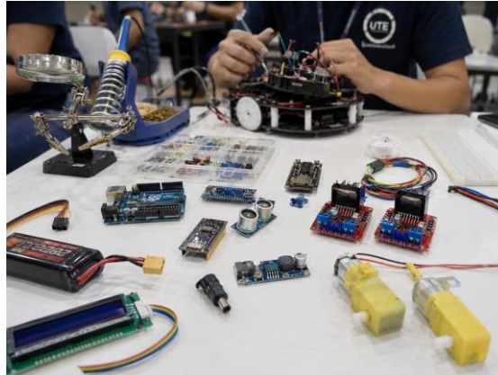
Figura 2.1: Componentes electrónicos utilizados en el desarrollo de robots competitivos.
