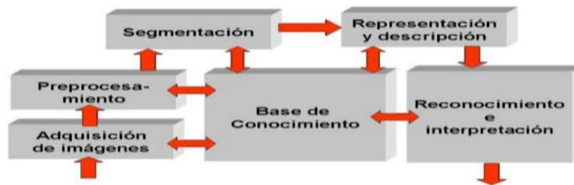
Figura 100. El proceso de la visión artificial
