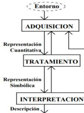
Figura 91. Diagrama de bloques del proceso de percepción
