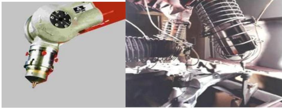
Figura 55. Herramienta terminal para suelda
